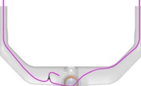
13 - Atraviese los latiguillos de freno por la base antes de colocar la base del manillar en el tubo de la horquilla.
