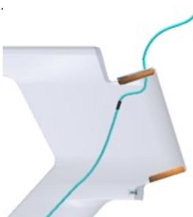
8 - Setzen Sie die Lager mit den abgeschrägten Seiten zum Rahmen hin ein und montieren Sie den Kompressionsring (siehe Steuersatzmontage).
