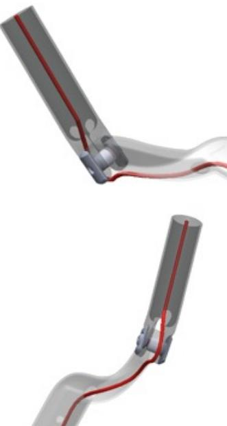
15.3 - Coloque el cable electrónico en la V (6) que soporta las extensiones y coloque la tapa una vez haya cableado ambas extensiones.
