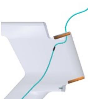
8 - Introduzca los rodamientos con las caras biseladas hacia el cuadro, y coloque la anilla de compresión (consulte montaje de la dirección).
