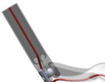
15.3 - Legen Sie das Kabel in das V (6), das die Extensions trägt, und bringen Sie die Abdeckung erst an, wenn Sie beide Extensions verlegt haben.
