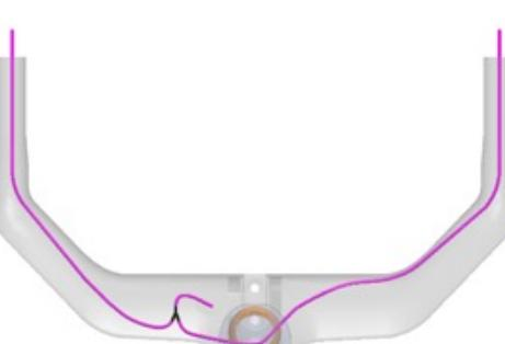
10 - Deslice el tubo de gomaespuma de 510 mm sobre el latiguillo de freno trasero.
