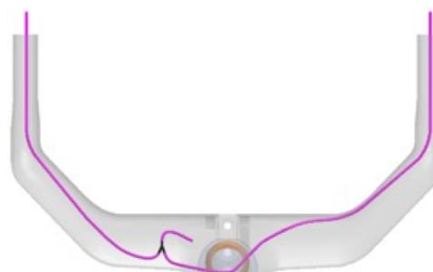
10 - Schieben Sie einen vorbereiteten 510-mm-Schaumstoffschlauch auf den hinteren Bremsschlauch.
