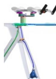
9 - Führen Sie den vorderen Bremsschlauch durch das linke Gabelbein und führen Sie ihn durch das obere Ende des Steuerrohrs (dunkelblauer Schlauch).
