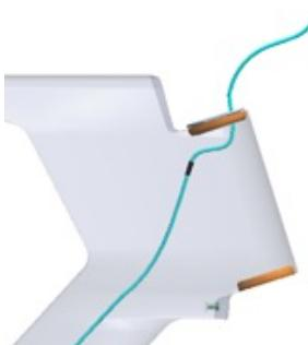
8 - Insérer les roulements cotés chanfreinés face au cadre, et positionner la bague de compression (Cf : Jeu de direction).
