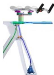
10 - Far scorrere un tubo di foam da 510 mm, già preparato, sul tubo del freno posteriore.
