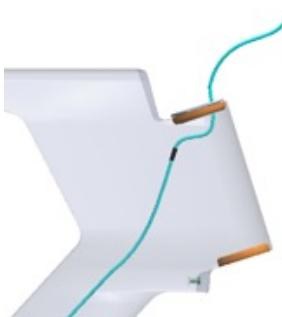
8 - Inserire i cuscinetti con i lati smussati rivolti verso il telaio e montare l'anello di compressione (vedere Montaggio della serie sterzo).
