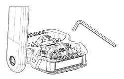
Die Einstellung kann nicht vorgenommen werden, wenn die Pedalplatte im Pedal eingerastet ist. Beim Verschrauben zeigt ein Anstieg der erforderlichen Kraftantrengung an, dass die maximale Einstellung erreicht wurde. Sobald dieser Punkt erreicht ist, sollten Sie aufhören zu schrauben, um eine Beschädigung des Pedals zu vermeiden.
