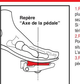
1. Réglage latéral de la cale : Si vous avez des pédales équipées du système Q-factor (CX 6 ou CX 7), centrez le plus possible la cale sous la chaussure (trou de fixation de la semelle au milieu des fenêtres de la cale) et utilisez le Q factor pour écarter la pédale de la manivelle quand vos talons touchent les bases du vélo.
