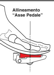
**1. Ajuste lateral de la cala:** Si tiene pedales equipados con el sistema Q-factor (CX 6 o CX 7), centre lo más posible la cala debajo de las zapatas (agujeros de fijación de la suela en medio de las ventanas de la cala) y utilice el Q factor para separar el pedal de la manivela cuando sus talones toquen las bases de la bicicleta. Si sus pedales no están equipados con Q-factor y sus talones tocan las bases, desplace la cala hacia el exterior del pedal. El ajuste lateral posible es de 4 mm.
