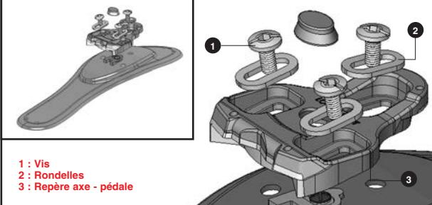
Dans le cas de l'utilisation de semelles en carbone il est conseillé d'intercaler un sticker abrasif entre la cale et la semelle afin d'éviter tout glissement de la cale sous la semelle. En général ces stickers sont livrés avec les chaussures.
