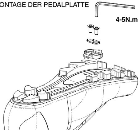
**angebracht sind, bevor Sie die Schuhe einrasten. Befestigen Sie die Pedalplatte unter der Schuhsohle nur mit den mitgelieferten Schrauben. Überprüfen Sie regelmäßig, dass die Pedalplatten unter dem Schuh nicht verrutscht sind, insbesondere wenn sie Carbon-Sohlen tragen.**
