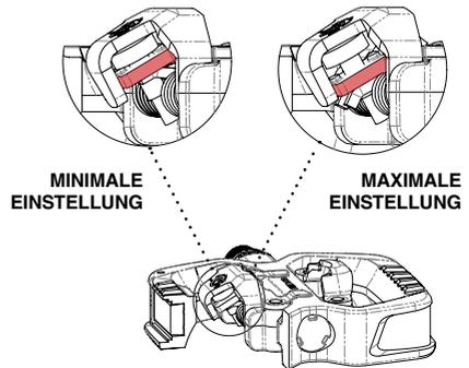
Die Einstellung kann nicht vorgenommen werden, wenn die Pedalplatte im Pedal eingerastet ist. Beim Verschrauben zeigt ein Anstieg der erforderlichen Kraftanregung an, dass die maximale Einstellung erreicht wurde. Sobald dieser Punkt erreicht ist, sollten Sie aufhören zu schrauben, um eine Beschädigung des Pedals zu vermeiden.
