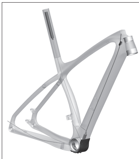
Schema di montaggio gruppo elettrico
