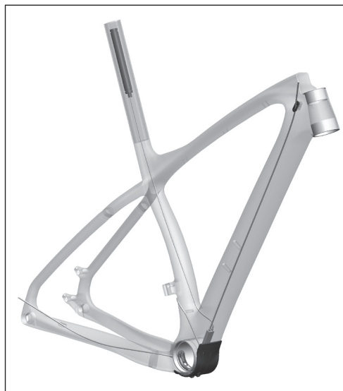
Esquema de montaje del grupo eléctrico
