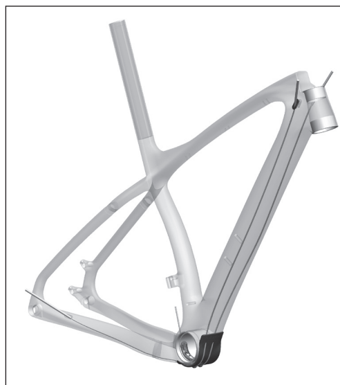
Schéma de montage groupes mécaniques
